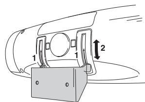
**i** Ruotare di nuovo il dispositivo di comando completamente in avanti prima di estrarlo dal supporto a parete!
