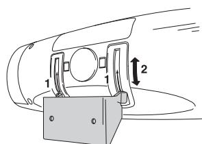
L'unité de commande peut être basculée sur le support mural et l'inclinaison ainsi adaptée. Un dispositif d'arrêt empêche que l'unité de commande à l'état basculé ne puisse être retirée du support mural.
